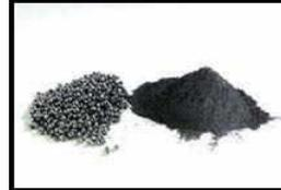
**DESCRIPCION DE PRODUCTO:** Producto de alta pureza 99.5% min. disponible en malla 200, malla 100 y shot soluble en ácido nítrico concentrado forma aleaciones binarias con plata, cobre, zinc y plomo.
